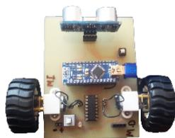
Fig. 2- Construcción Carrito detector de obstáculos
