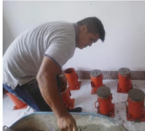
*Figura 17. Figura 18.* Elaboración de testigos de concreto sin aditivo.
