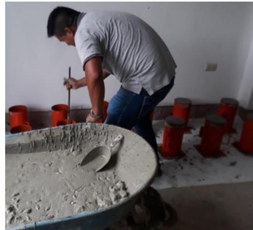
*Figura 19. Figura 20.* Elaboración de testigos de concreto con aditivo SikaCem plastificante en polvo.
